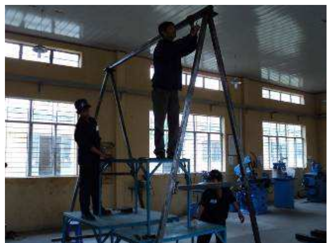
Photo 5: Testmontage des 500 Kg Kran
