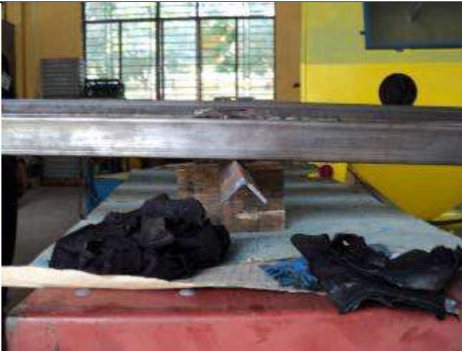
Photo 19. Wichtig, die Lehrlinge, wie die Lehrer müssen lernen, dass eine Punktauflage das Malen vereinfacht; respektive verschnellert.
