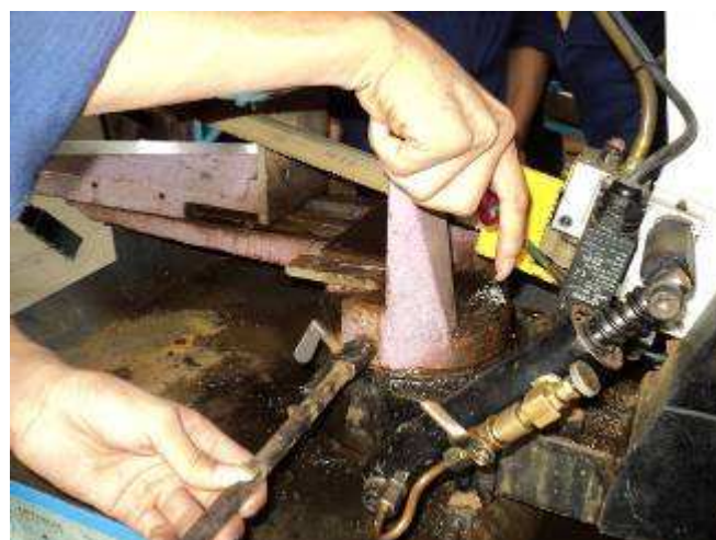
Photo 10: Alles war verrostet. Mind. 3 Stunden musste man nur entrostet, und jetzt ist es verboten ohne Kühlmittel zu sägen
